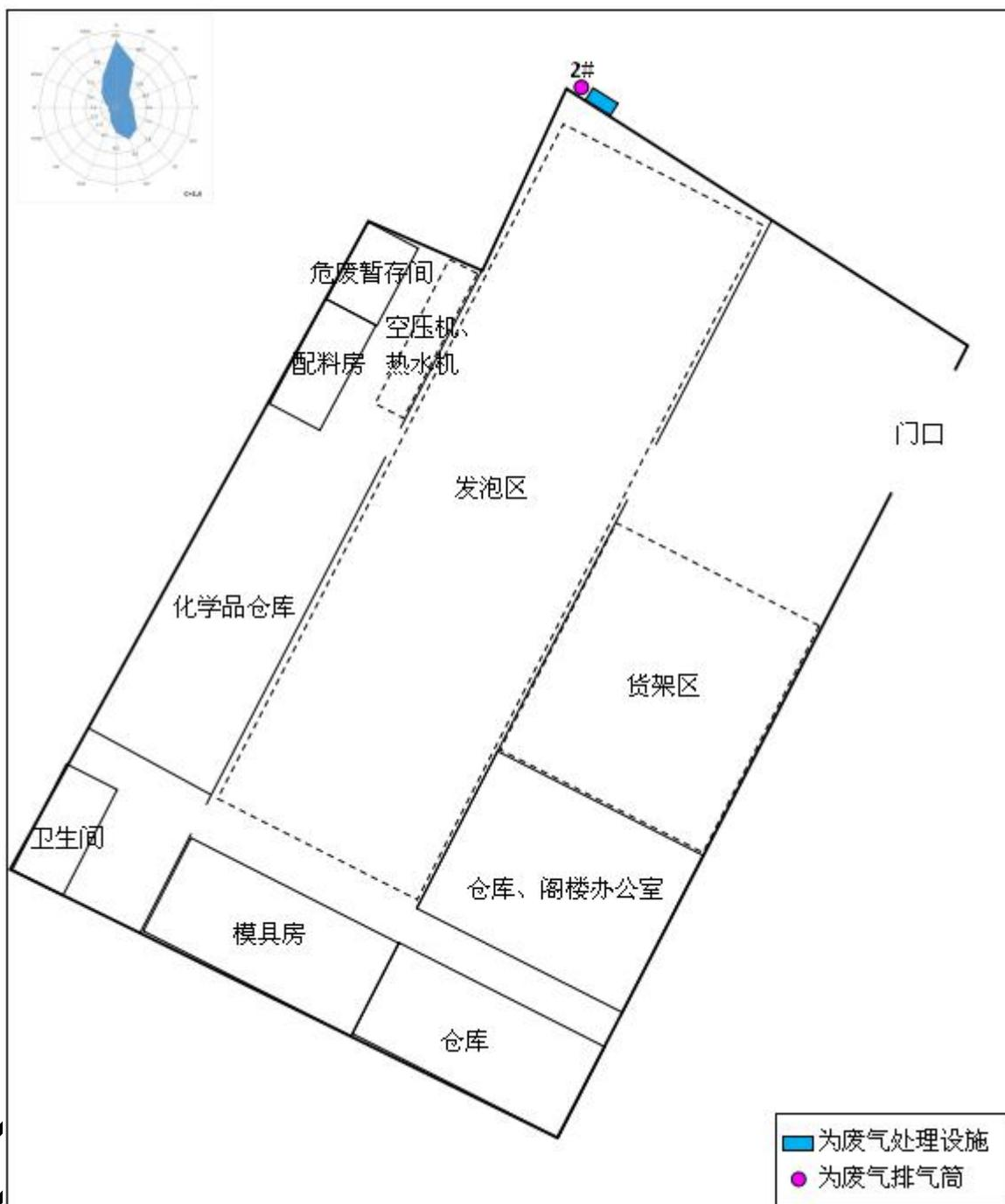
图4.1-5 本次扩建项目平面布置图（发泡车间）
